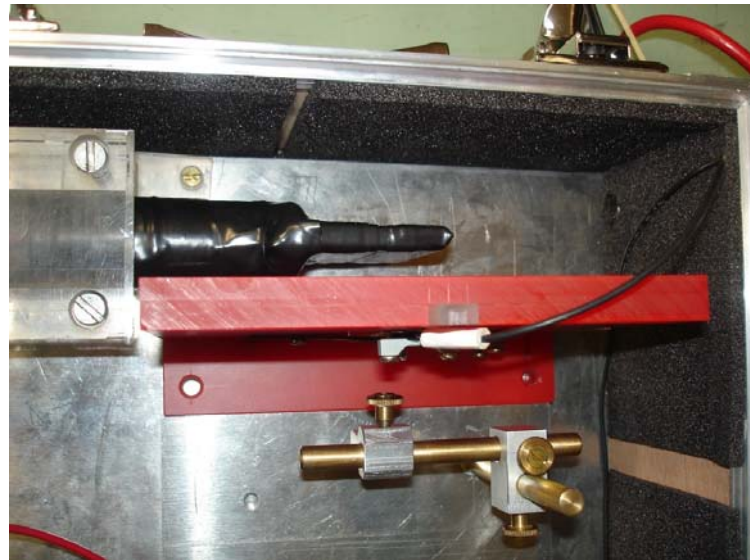
Bild 3.6: Trigger mit Photomultiplier und Szintillator
