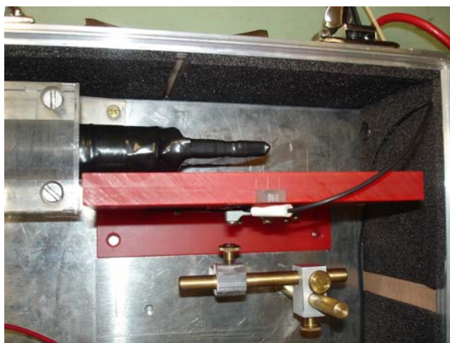
Bild 5.3: Befestigung des MPPC in den Stäbchen mit Verbindung zur elektronischen Auslese
